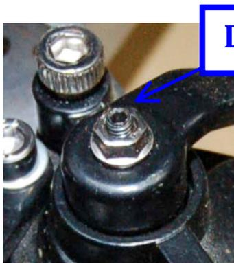
Nun muss der schwarze Gewindestift wieder nach rechts gedreht werden, so dass die innere Bremsbacke langsam zugestellt wird. Dabei darf die Bremsscheibe natürlich nicht festgeklemmt werden. Das Rad sollte sich leicht drehen lassen.
