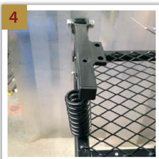
**NL** Monteer de asbeugel met de montageplaat naar de binnenzijde met de M10x55 bout, ring en moer zodat deze spelingvrij kan scharnieren t.o.v. de beugel op het basisframe.
