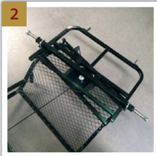
**NL** Verwijder de U-beugels van het draaiplateau en monteer de vooras met de aanslagnokken tegen de montageplaat. Zet de as daarna goed vast met de U-beugels.
