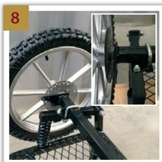
**NL** Monteer de achterwielen met de remschijven op de achteras. De moer van de asbus moet tussen de remschijf en het frame zitten. Zet het wiel met de borgmoeren vast aan de buitenzijde van het frame.
