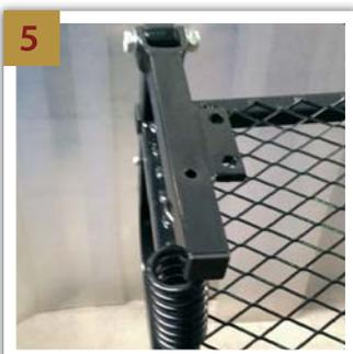
**NL** Monteer de asbeugel aan de asveer met de M8x45 bout, ring en moer en zet de bouten aan de boven- en onderzijde van de veer goed vast.
