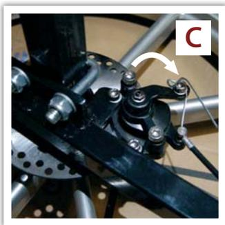
**NL** De remhendel moet met de hand in de richting van de pijl ca. 50 – 70% van de weg worden voorgespannen, draai daarna de Bowdenkabel met een tang rond de schroef en draai de schroef aan. Eventueel moet deze stap nogmaals worden herhaald.
