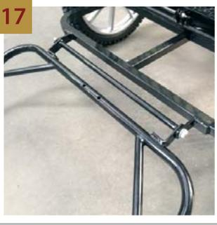
**NL** Monteer de U-beugel met de stelbouten van de lamoenstukken naar beneden en draai de u-beugel vast zodat deze nog net scharniert.
