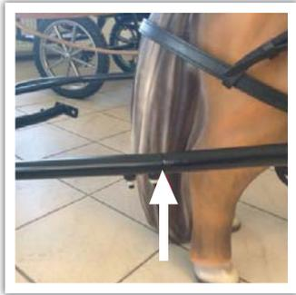
**NL** Uw lamoen wordt zwaarder belast naarmate de Sulky niet in balans is. Er zijn een aantal punten waarop na verloop van tijd metaalmoeheid kan ontstaan. Wees daarop bedacht! Belasting van materiaal ontstaat meestal op bevestigingspunten. Daarom het volgende:
